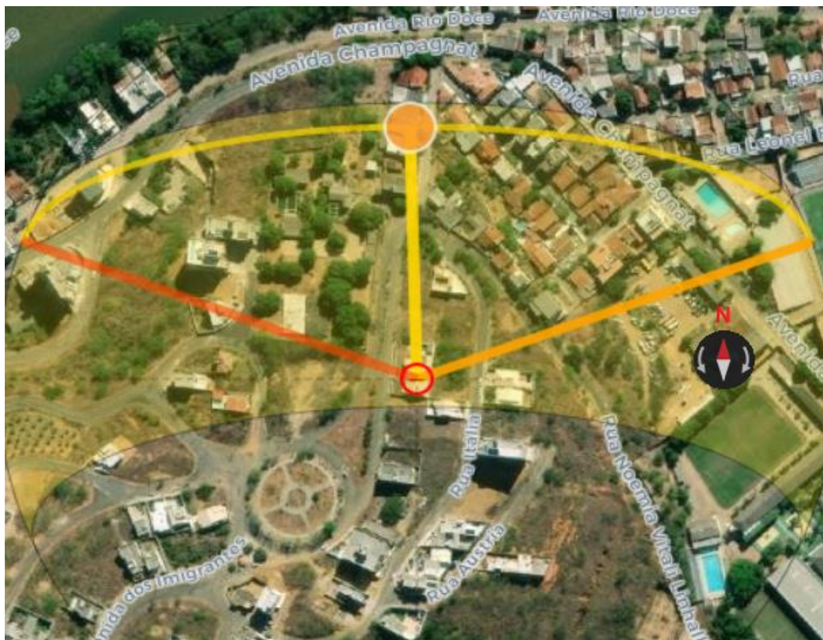
Figura 2 – Incidência da radiação solar diária na residência estudada. Fonte: Modificado do SunCalc.
