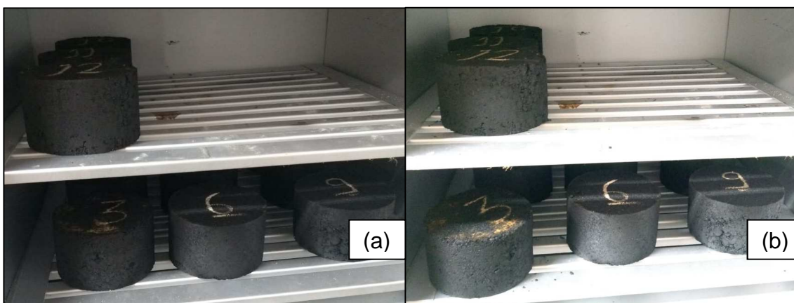
Figura 2: Corpos de prova no primeiro dia (a) e no 21º dia de incubação (b).
