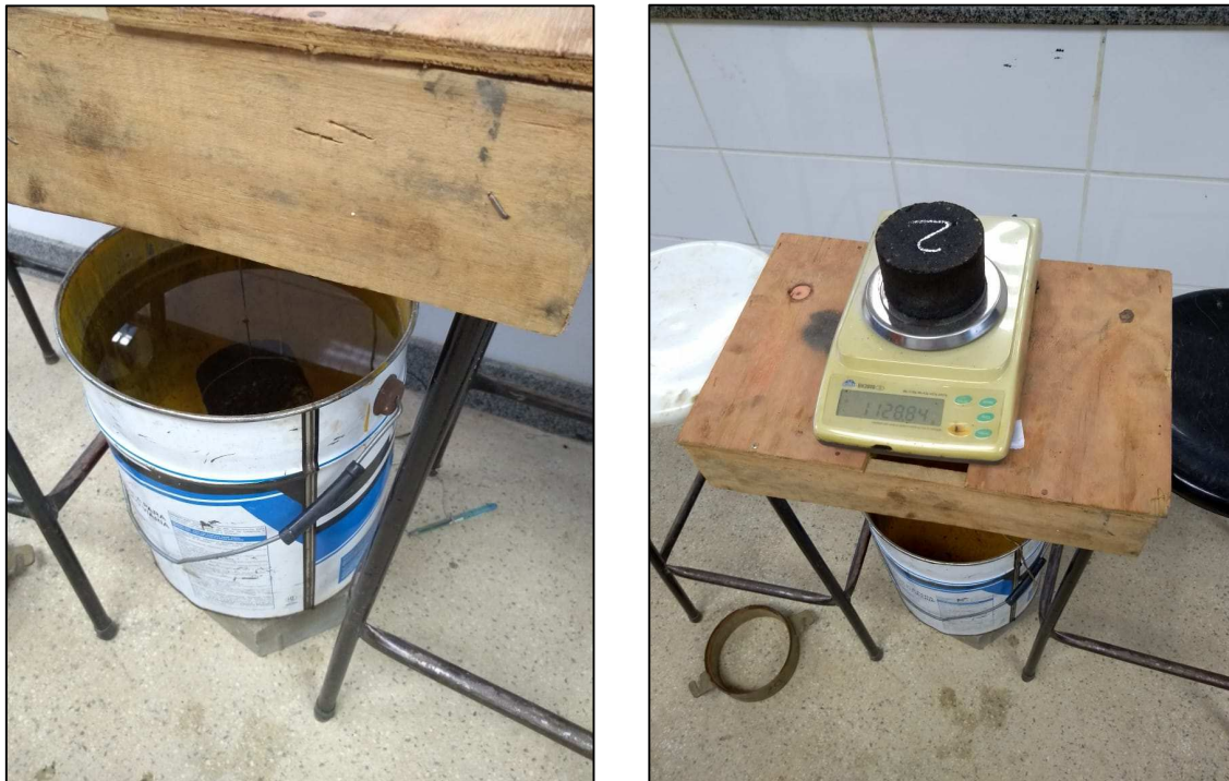
Figura 1: Corpo de prova A1/2 no processo de pesagem imerso em água e no ar, respectivamente.
